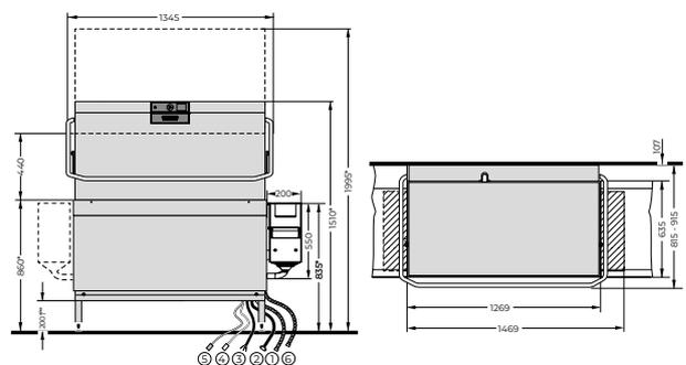
Maximale Tischprofilhöhe bei AMXXL und AUPL in Eckaufstellung: 40 mm.
